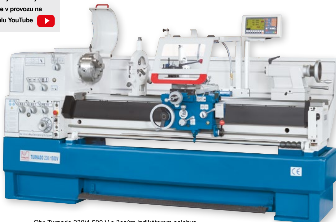
Obr. Turnado 230/1 500 V s 3osým indikátorem polohy a plynulým nastavením počtu otáček
